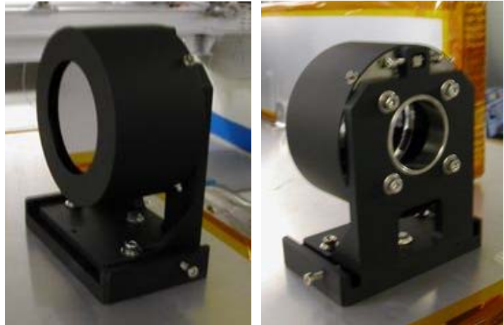
Figure 2.2-7. Vue avant (gauche) et arrière (droite) du miroir de vol dans sa monture.
