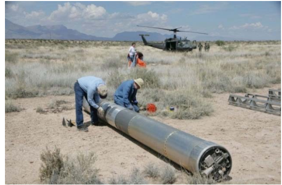
Figure 2.4-3. Récupération la charge utile après le vol. Le parachute orange est visible à l'arrière-plan.
