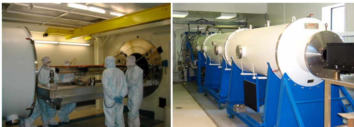
Figure 2.2-13. La chambre SCOTCH du NRL. Gauche : le tube du collimateur. Le collimateur EUV était positionné à la place de la boîte noire. Droite : de l'autre côté du mur du fond sur la photo de gauche, en zone propre, la grande cuve et la table orientable sur laquelle est monté HeCOR. Le collimateur est à droite de l'autre côté du mur, en zone grise. L'ensemble du système est mis sous vide durant les tests.
